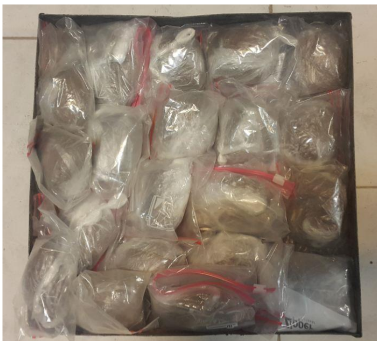
شکل ۵. نمونه های ساخته شده تحت عمل آوری جهت آزمایش حدود اتربرگ
