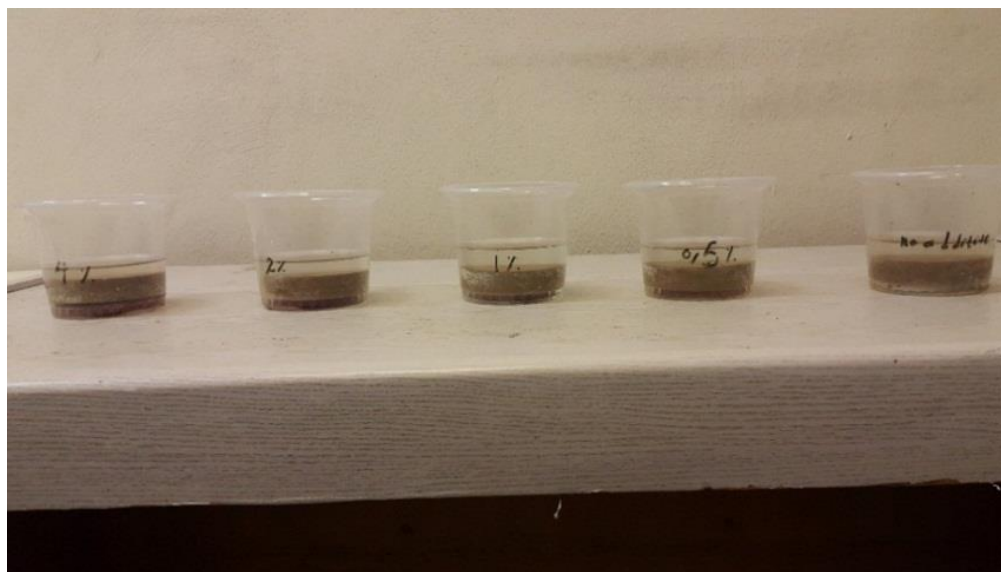
شکل ۷. نمونه ها تحت سیکل تر و خشک
