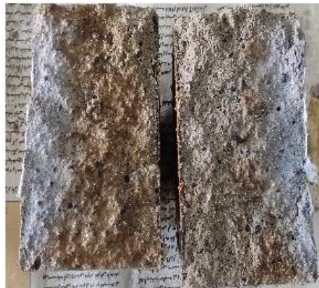
شکل ۴. نمونه ملات ژئوپلیمری ساخته شده از کائولن و سرباره بعد از پاشش محلول نیترات نقره برای انجام آزمایش RCMT.
