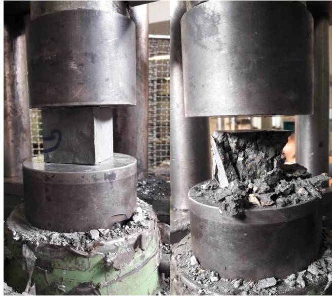
شکل ۳. آزمایش مقاومت فشاری قبل و بعد از شکست نمونه
