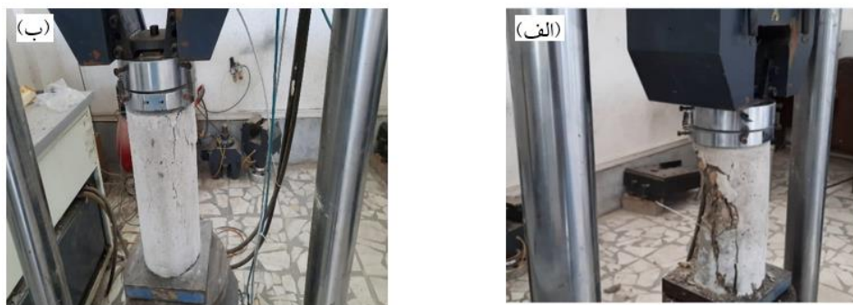
شکل ۱۳. (الف) نمونه بدون خرده لاستیک و الیاف لاستیک؛ (ب) نمونه با خرده لاستیک و الیاف لاستیک
