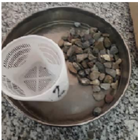
شکل ۱. سنگدانه های با اندازه دانه ۱۲/۵-۱۹ mm پس از آزمایش سلامت سنگدانه (ASTM C88) نمونه خاک اصلاح نشده
