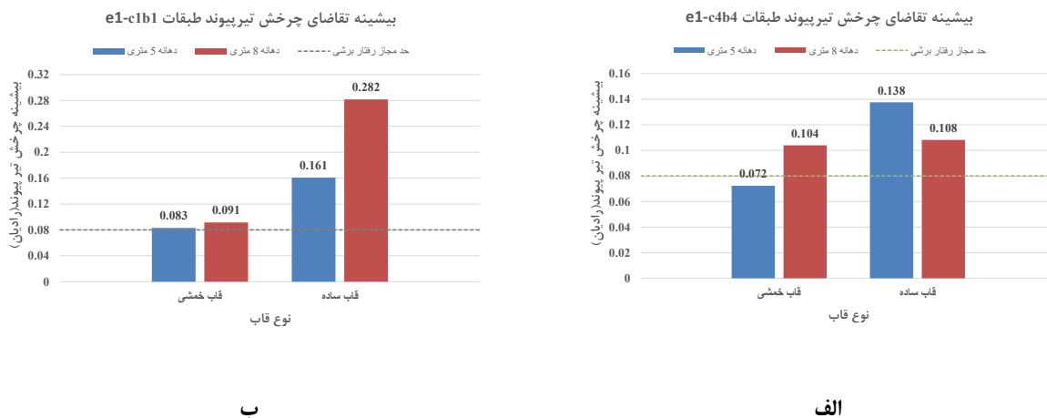
شکل ۱۸. بیشینه تقاضای چرخش تیر پیوند طبقات دهانه ۵ و ۸ متری e=1\text{ m} - حالت حذف طبقه اول و چهارم، الف - حالت حذف طبقه چهارم، ب - حالت حذف طبقه اول
