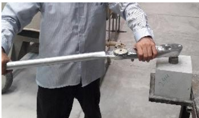
(ب) نحوه قرارگیری آچار روی استوانه (b) How to place the wrench on the cylinder
