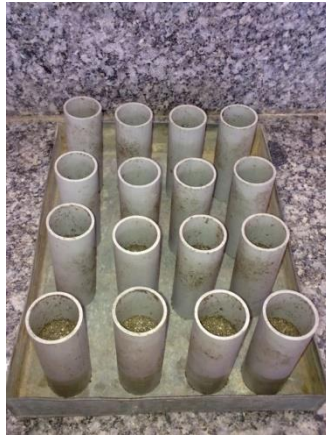
شکل ۱. قالب گیری آزمون های استوانه ای شکل جهت انجام فرآیند یخبندان-ذوب و آزمایش مقاومت فشاری.
