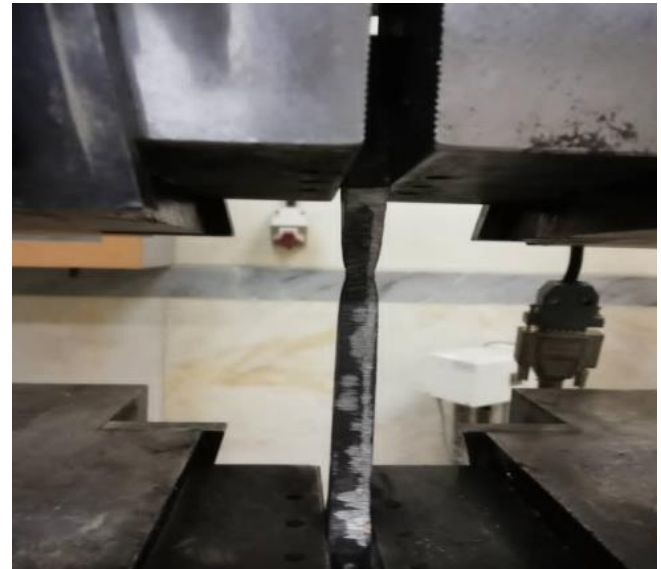
شکل ۵. تست کشش جهت تعیین مشخصات فولاد
