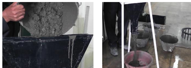
شکل ۵. الف- مراحل آزمایش جریان اسلامپ، ب- مراحل آزمایش جعبه L، مراحل آزمایش حلقه J، د- مراحل آزمایش قیف V
