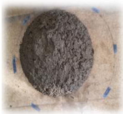
شکل ۴. آزمایش جریان اسلامپ، نمونه ساخته شده براساس طرح مخلوط ICAR
