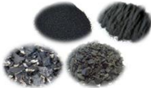
شکل ۳. لاستیک در ابعاد مختلف براساس استاندارد اروپا (ETRA)
