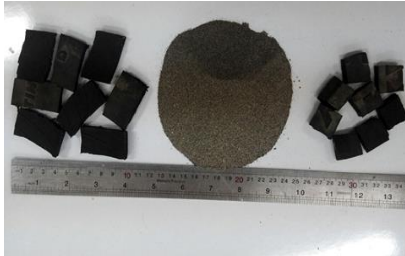
شکل ۴. تصویری از ماسه و خرده لاستیک ۲×۲ و ۲×۴ cm
