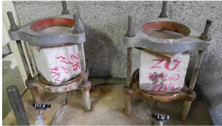
شکل ۸. قرارگیری نمونه‌ها در دستگاه عمق نفوذ آب
