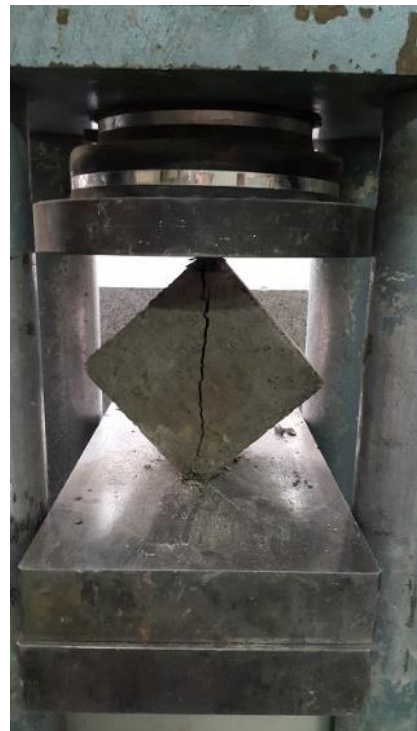
شکل ۹. دو نیم شدن نمونه‌ها توسط دستگاه
