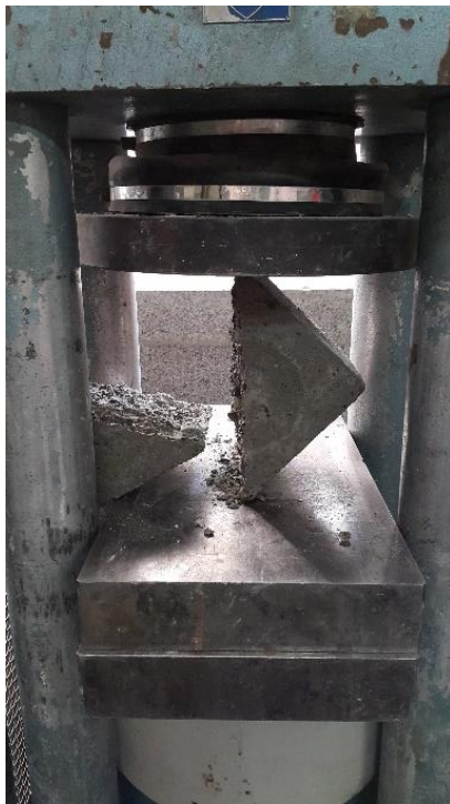
شکل ۱۰. دو نیم شده نمونه‌ها توسط دستگاه
