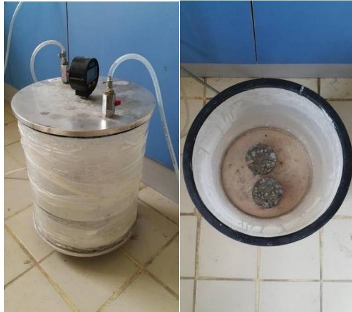
شکل ۴. قرارگیری نمونه‌ها در شرایط خلأ
