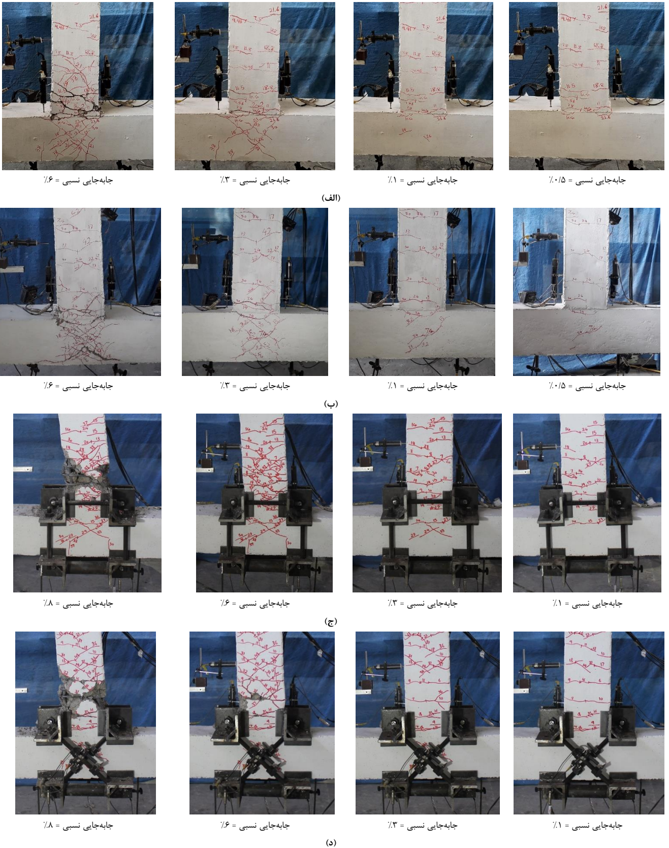
شکل ۷. رشد ترک‌ها و پیشرفت خرابی؛ الف) نمونه استاندارد (St)، ب) نمونه کنترلی (C)، ج) نمونه تقویتی افقی-قایم (HV)، د) نمونه تقویتی مورب (Di)
