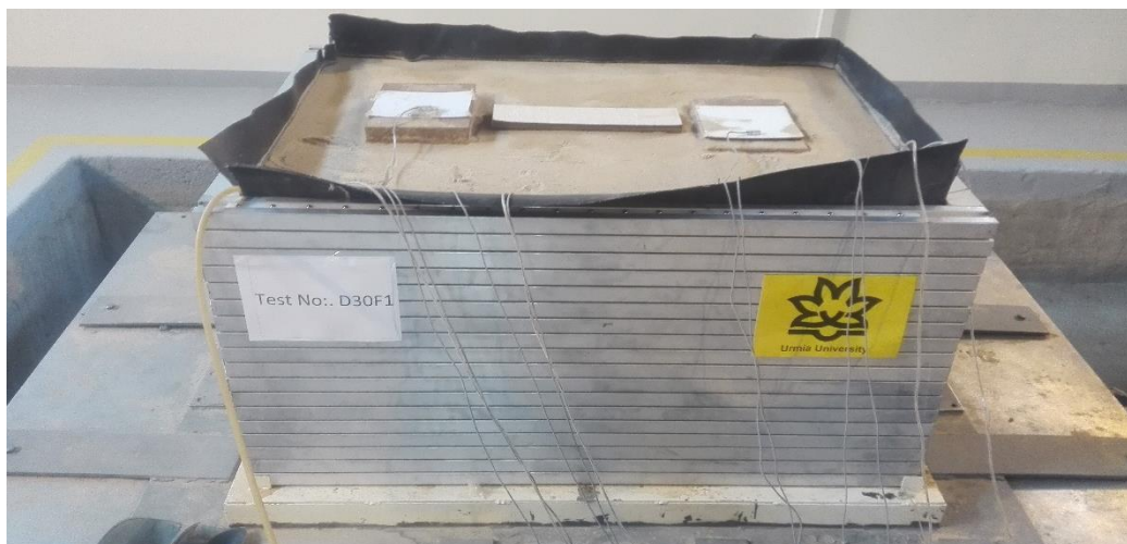
شکل ۱. میز لرزه و جعبه انعطاف‌پذیر دانشگاه ارومیه
