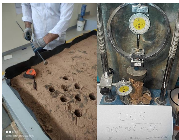
شکل ۴. مقاومت تک محوری ستون‌های اختلاط عمیق DSM
