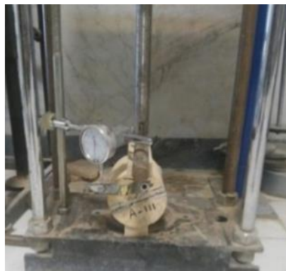
شکل ۷. الف) نحوه اجرای تست برزیلی بر روی مغزه‌ها، ب) وضعیت نمونه‌ها و مود گسیختگی پس از آزمایش
