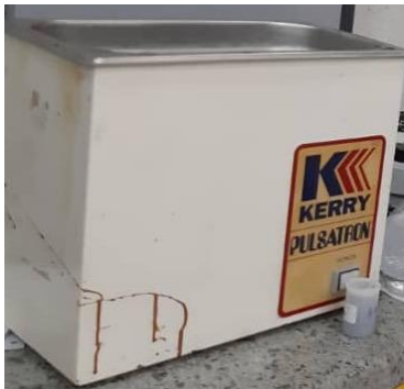
(ب) دستگاه حمام اولتراسونیک (b) Ultrasonic treatment
