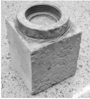
(ب) صفحه فلزی چسبانده شده روی نمونه مکعبی (b) Metal plate glued on the cubic sample
