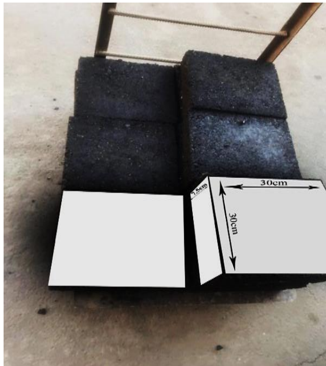
شکل ۷. نمونه‌های بتن آسفالتی ساخته شده با ابعاد جعبه‌ی برش مستقیم بزرگ مقیاس
