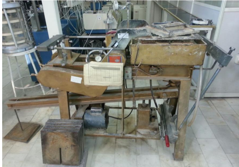
شکل ۲. دستگاه برش مستقیم بزرگ مقیاس مورد استفاده در پژوهش
