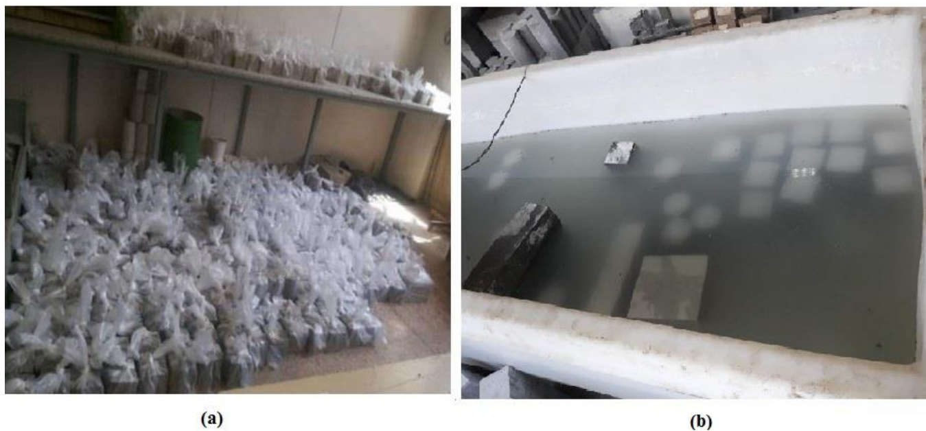
شکل ۱. شرایط عمل‌آوری (الف) در پوشش پلاستیک، (ب) در آب
