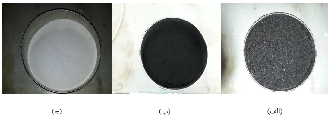
شکل ۲. تصویر (الف) پودر شیشه، (ب) لاستیک اندازه ۰/۱۵-۱ mm، (ج) لاستیک اندازه ۳-۵ mm مورد استفاده در این پژوهش
