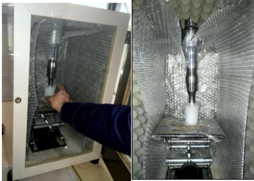
شکل ۵. ترکیب آب و نانو سیلیس به وسیله‌ی یک همگن‌ساز اولتراسونیک
