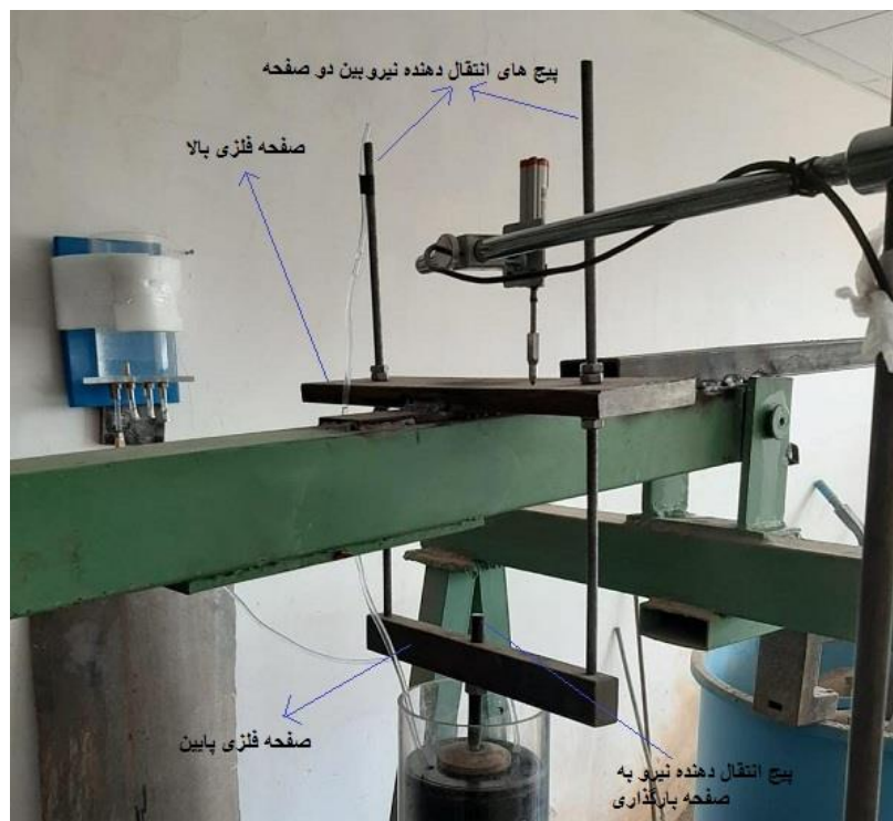
شکل ۵. نحوه انتقال نیرو به صفحه بارگذاری روی نمونه
