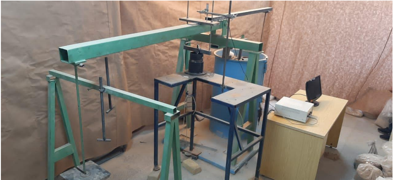
شکل ۴. اجزای دستگاه ارزیابی پتانسیل رمبندگی با قابلیت مدل‌سازی نوع نشت آب
