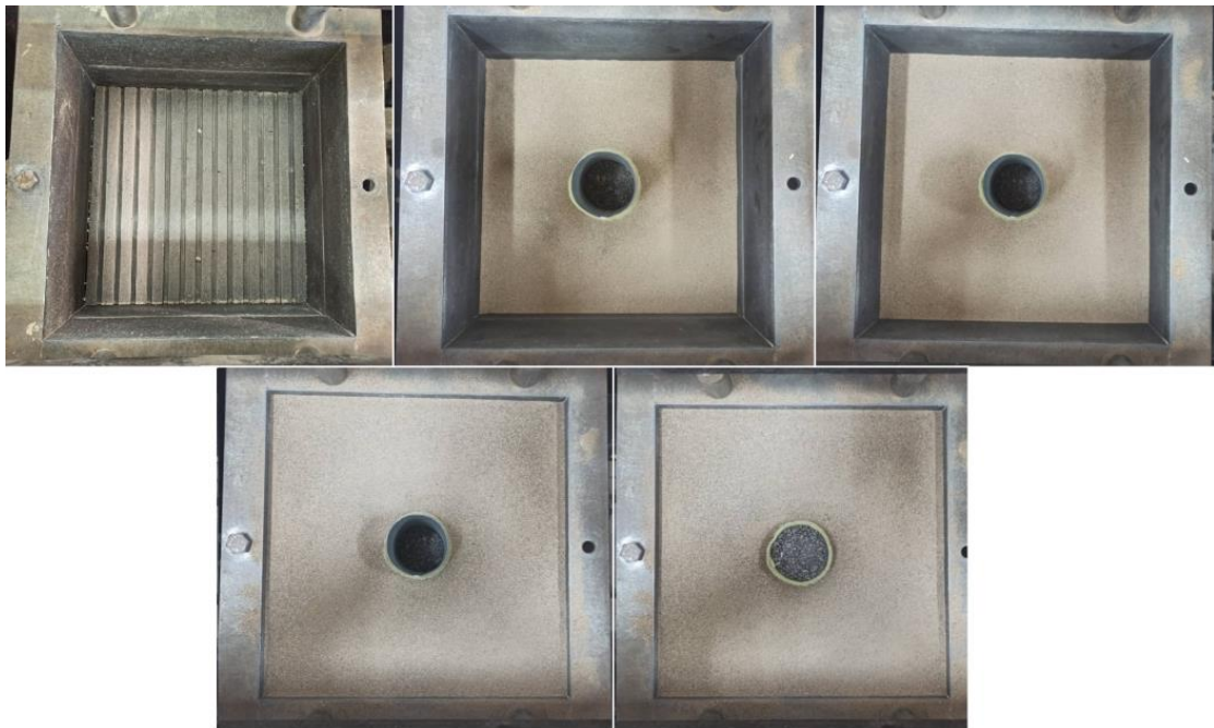
شکل ۵. مدل کردن ستونها در جعبه دستگاه با ژئوتکستایل
