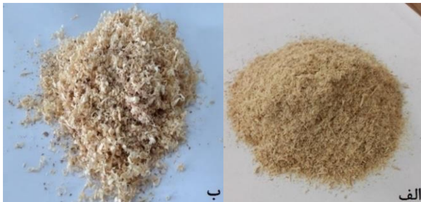
شکل ۴. الف) پودر خاکاره، ب) الیاف خاکاره
