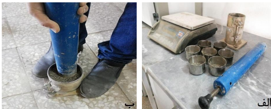
شکل ۵. مراحل انجام آزمایش تراکم - الف) تجهیزات لازم، ب) کوبش خاک با چکش
