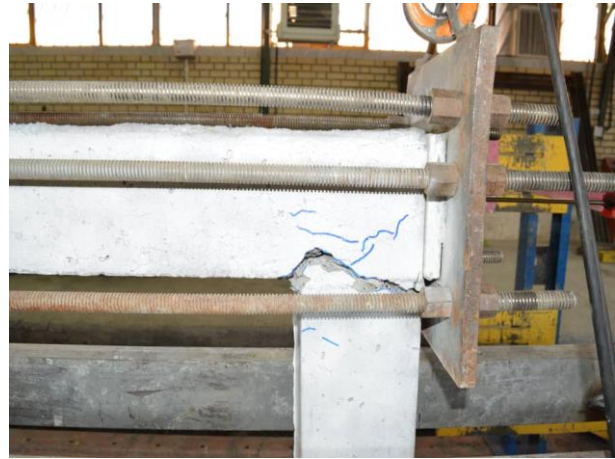
الف) گسترش ترک و آسیب در محل اتصال تیر به ستون
