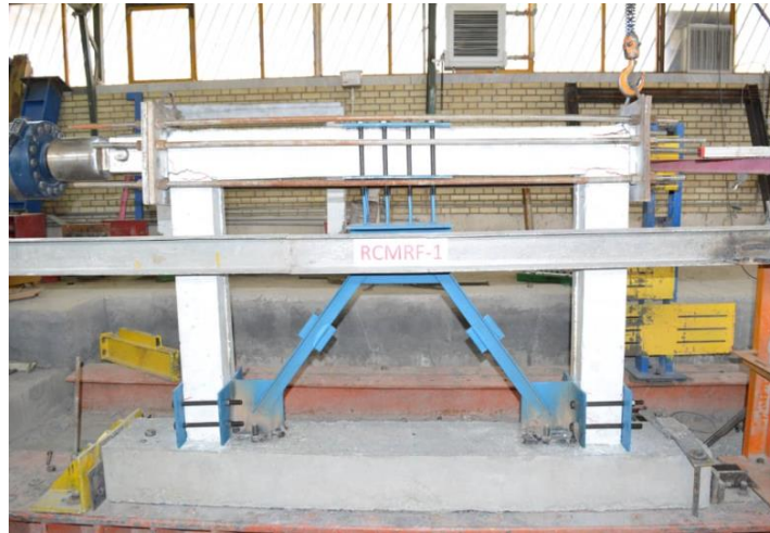
شکل ۶. مدل با میراگر پیشنهادی در قاب خمشی بتنی
