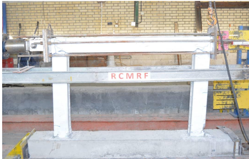
شکل ۱. مدل سازه قاب بتنی بدون میراگر
