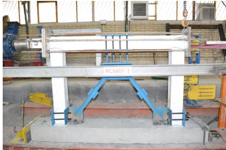
شکل ۲. مدل سازه قاب دارای میراگر تسلیمی NSD
