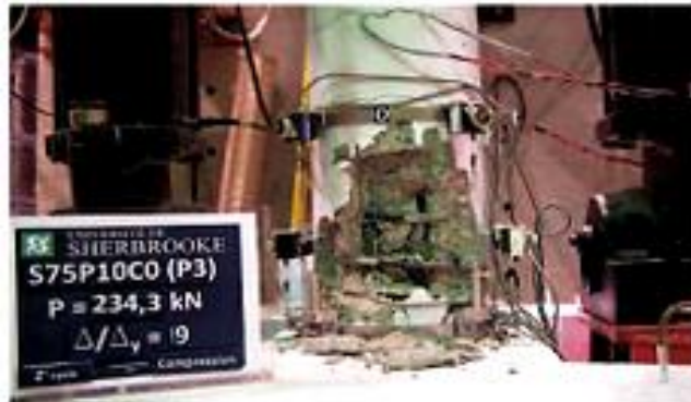
شکل ۷. خرابی نمونه ستون بتنی در اثر بارگذاری در آزمایش پالتر و همکاران [۳۶]
