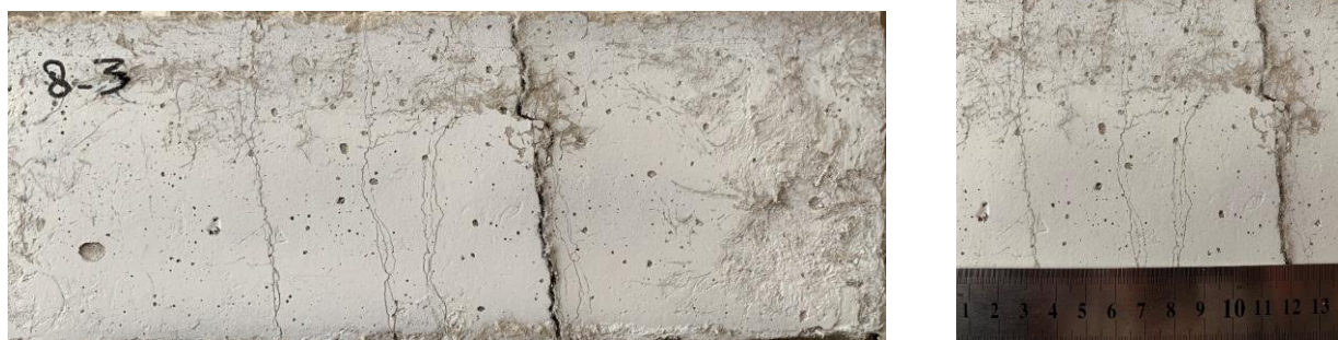
شکل ۵. نحوه شکست و تشکیل ریز ترک‌ها در نمونه خمشی
