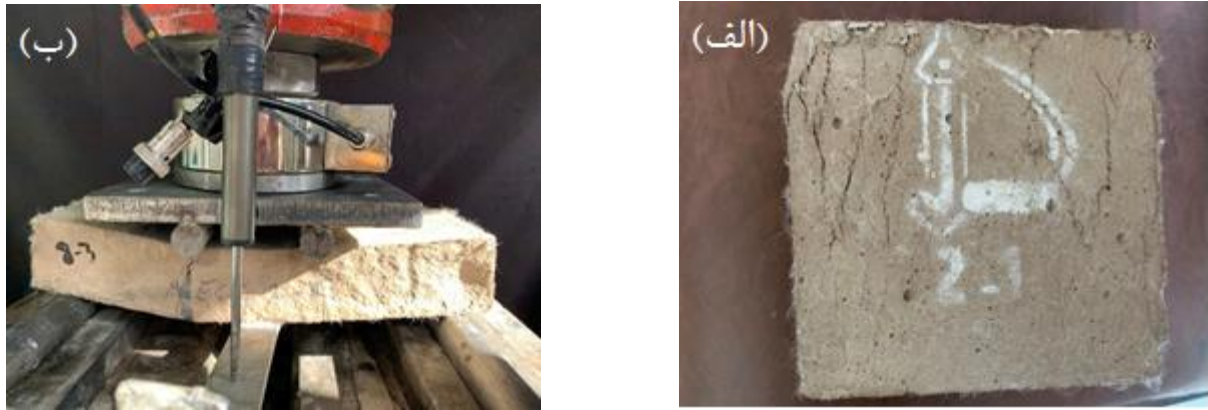
شکل ۳. (الف) شکست در نمونه فشاری (ب) آزمایش خمشی چهار نقطه‌ای Fig. 3. (a) Fracture in compressive test (b) Four-point bending test
