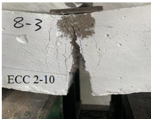
شکل ۸. نحوه شکست نمونه WFM و تشکیل ریز ترک‌ها
