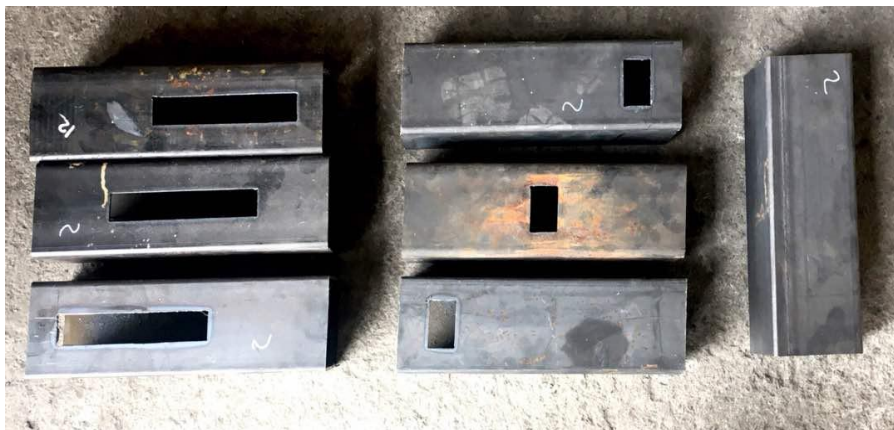
شکل ۶. تصاویر نمونه‌های سالم و سوراخ دار پس از برش
