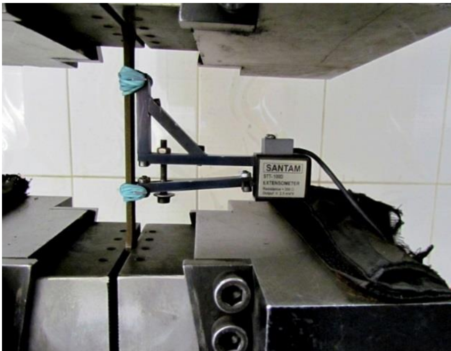
شکل ۲. تصاویر آزمایش کششی نمونه‌ها همراه با اکستنسومتر
