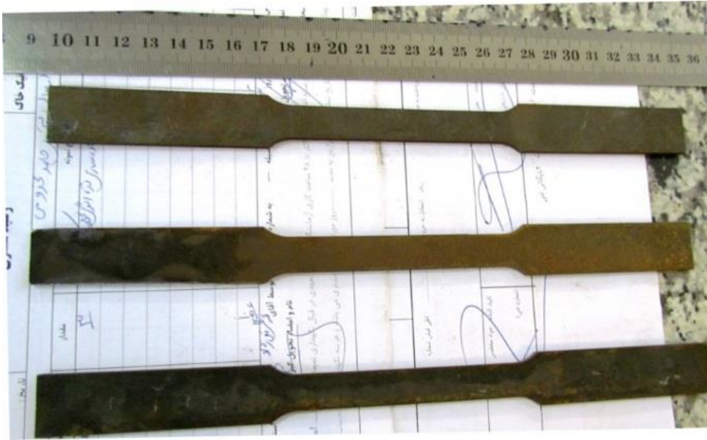
شکل ۱. تصاویر نمونه‌های آزمون کششی با نمایش طول آن‌ها
