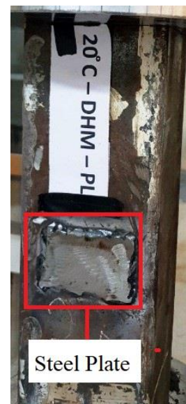
شکل ۱۲. نحوه مقاوم‌سازی نمونه‌ها به وسیله ورق‌های فولادی
