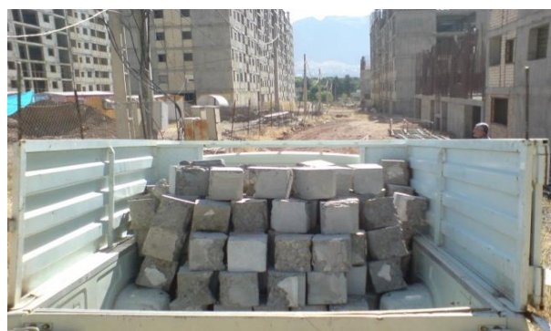
شکل ۳. نمونه‌های دیو شده مکعبی شکل بتن قدیمی و انتقال به کارخانه سنگ‌شکن
