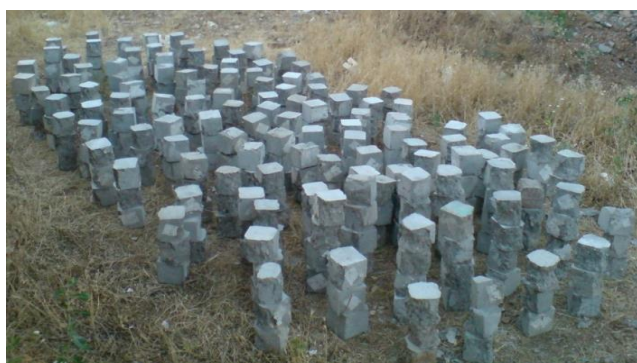
شکل ۳. نمونه‌های دیو شده مکعبی شکل بتن قدیمی و انتقال به کارخانه سنگ‌شکن
