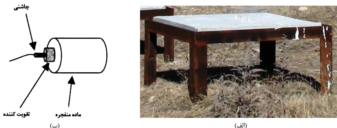
شکل ۴. نحوه انجام آزمایش انفجار: (الف) تکیه‌گاه مورد استفاده جهت تست انفجار، (ب) جزئیات خرج انفجاری (ماده منفجره)
