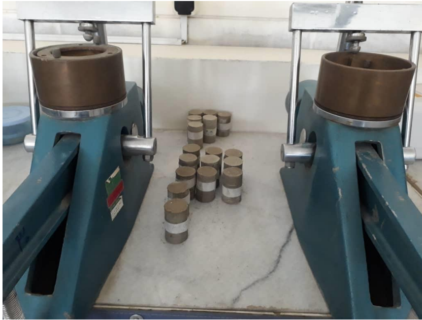
شکل ۳. تصویر شرایط عمل‌آوری نمونه‌های تک محوری ساخته شده در تحقیق
