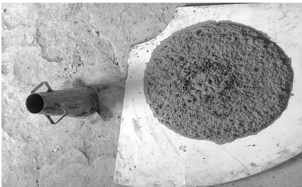
شکل ۲. نمونه تحت آزمایش اسلاپ
