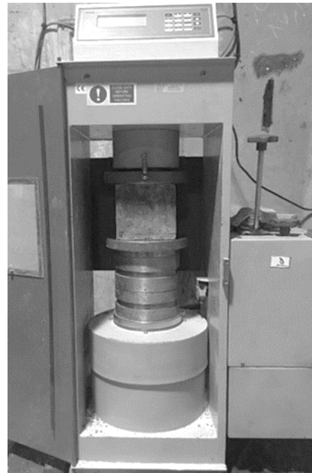
شکل ۷. دستگاه آزمایش مقاومت فشاری
