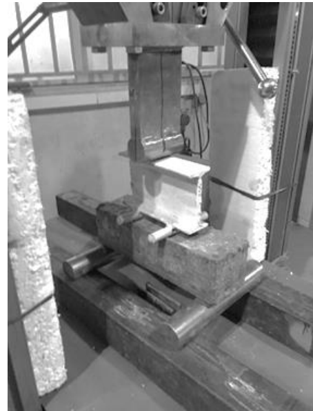
شکل ۱۲. نمونه تحت خمش با دستگاه zwick roell
