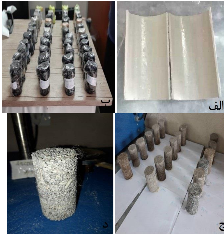
شکل ۵. مراحل ساخت و عمل‌آوری نمونه‌ها - الف) قالب آزمایشگاهی PVC، ب) عمل‌آوری نمونه‌ها داخل پوشش مرطوب، ج) نمونه‌های خارج شده از پوشش مرطوب، د) تصویری از یک نمونه قبل از انجام آزمایش تک‌محوری
