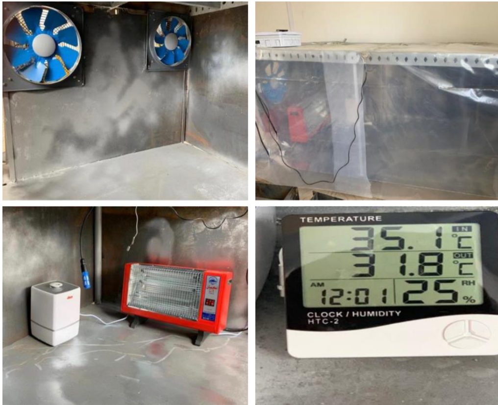
شکل ۵. محفظه‌ی محیطی، سیستم‌های ایجاد و اندازه‌گیری شرایط محیطی
