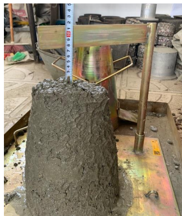
شکل ۳. اندازه‌گیری مقدار اسلامپ بتن روسازی مطابق با استاندارد ASTM C143
