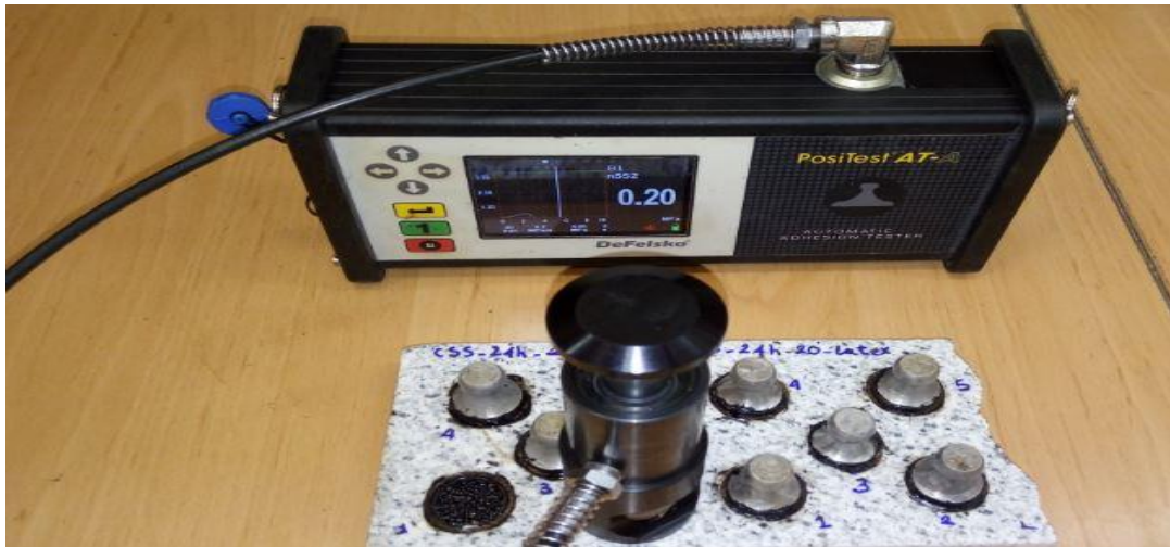
شکل ۲. دستگاه مقاومت کشش و کنده شدن Posi Test AT-A
