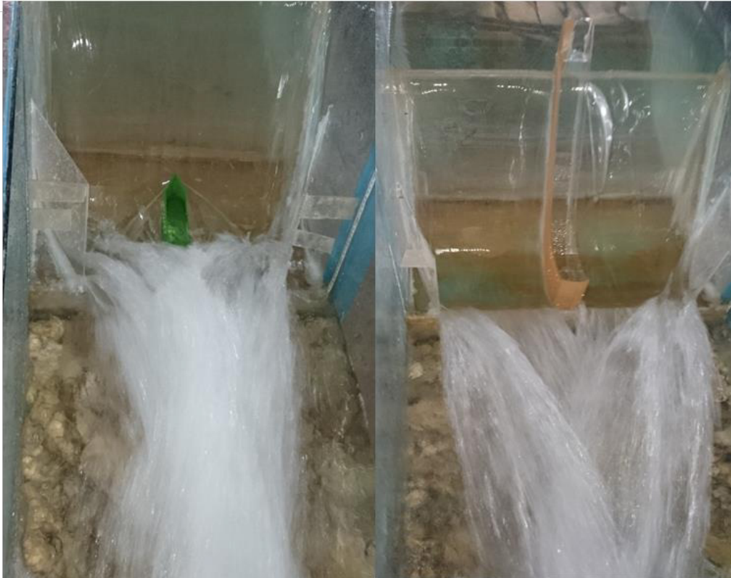
شکل ۱. پرتاب کننده جامی همگرا با دیواره جداکننده در جام و دیواره جداکننده سرتاسری
