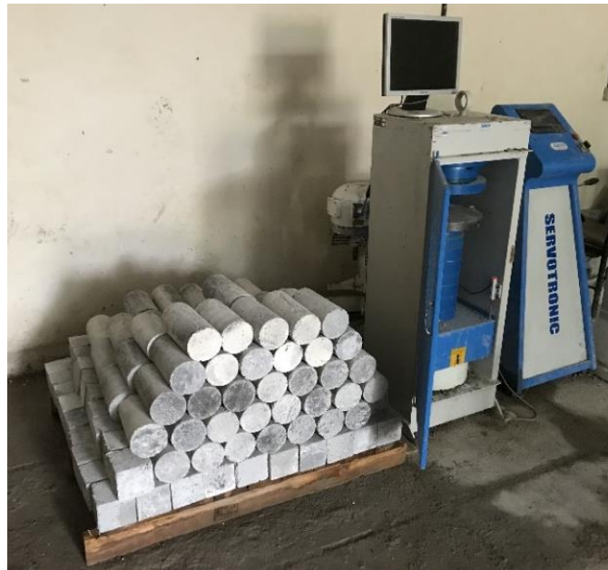
شکل ۱۲. نمونه‌ها و دستگاه مورد استفاده در انجام آزمایش مقاومت فشاری.
