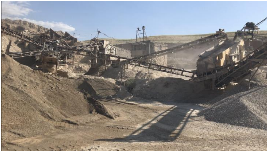
شکل ۳. سنگ شکن مورد استفاده در بازیافت نخاله‌های بتنی.
