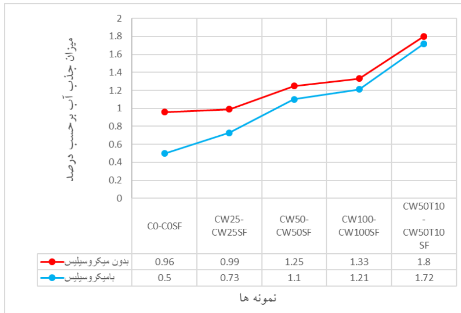
شکل ۷. جذب آب نمونه‌های حاوی میکروسیلیس و بدون میکروسیلیس
