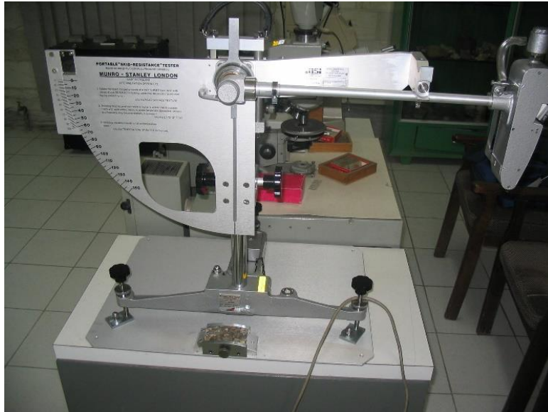
شکل ۲. دستگاه پاندول انگلیسی
