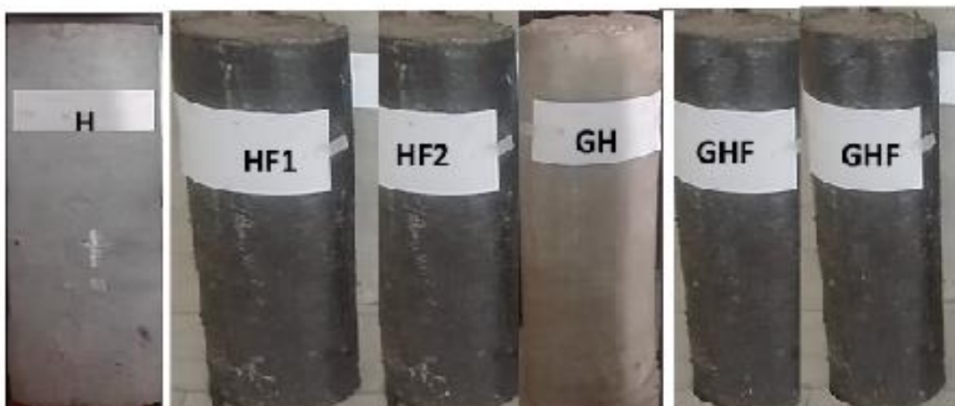
شکل ۴. ستون‌های تحقیق پس از دورپیچی با CFRP
