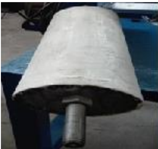
شکل ۲. قالب بیضی ساخت ستون‌ها
