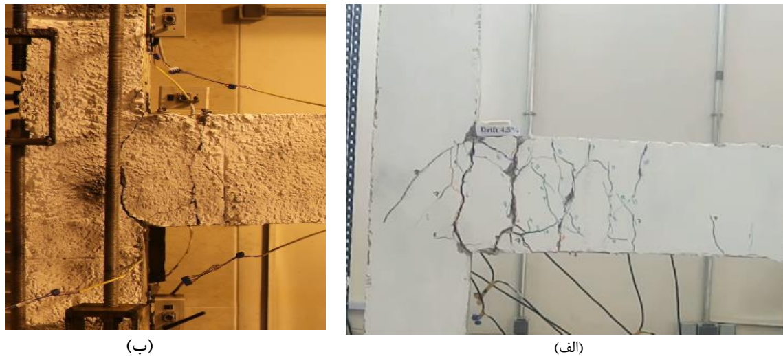
شکل ۴. الف. نمونه اتصال بتن ژئوپلیمری در انتهای تغییر مکان جانبی نسبی ۴٪. ب. نمونه اتصال بتن معمولی در انتهای تغییر مکان جانبی نسبی ۲/۷۵٪
