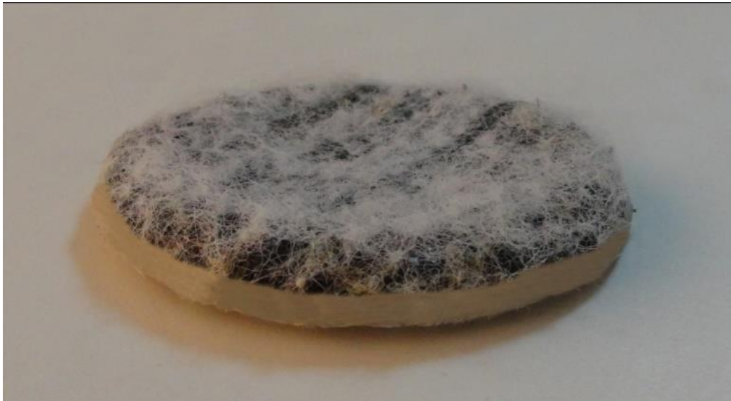
شکل ۲. مشخصات نمونه GCL آماده شده برای آزمایش نفوذپذیری
