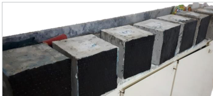
شکل ۲. نمونه‌های بتنی تقویت شده با ورق CFRP Fig. 2. Concrete specimens strengthened with CFRP sheets
