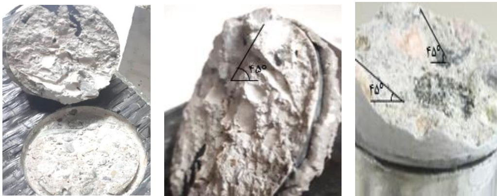
شکل ۱۸. نمونه‌هایی از مود گسیختگی حاصل از آزمایش «پیچش».
