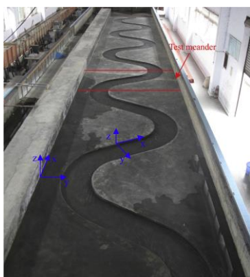
شکل ۴. نمایی از هندسه کانال مرکب پیچان [۱۷ و ۱۹] Fig. 4. Geometry view of meandering compound channel
