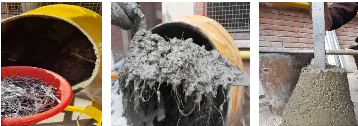
شکل ۳. ساخت مخلوط‌های بتنی و ارزیابی اسلامپ مطابق با استاندارد ASTM C143
