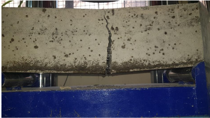
شکل ۵. تعیین مقاومت خمشی تیرهای بتنی مطابق با استاندارد ASTM C78
