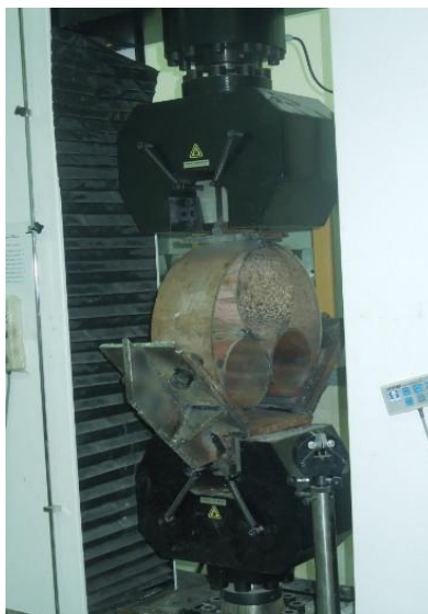
شکل ۵. شیوه ی جاگذاری نمونه آزمایشگاهی در دستگاه بارگذاری چرخه ای
