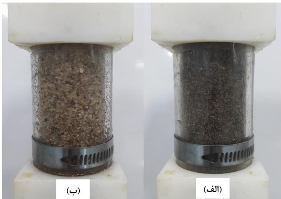
شکل ۷. نمایی از نمونه‌های (الف) آلوده با ۵ درصد نفت خام و (ب) شسته شده با محلول SDS با غلظت ۵۰۰۰۰ ppm
