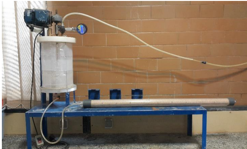
شکل ۵. شمایی از مخزن و استوانه تزریق مورد استفاده
