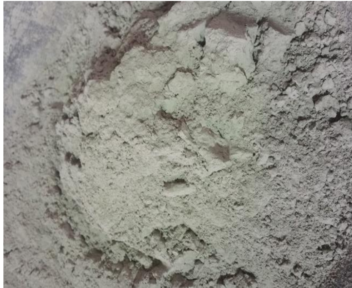
شکل ۱. بودر پومیس طبیعی تفتان Fig. 1. Taftan natural pumice powder
