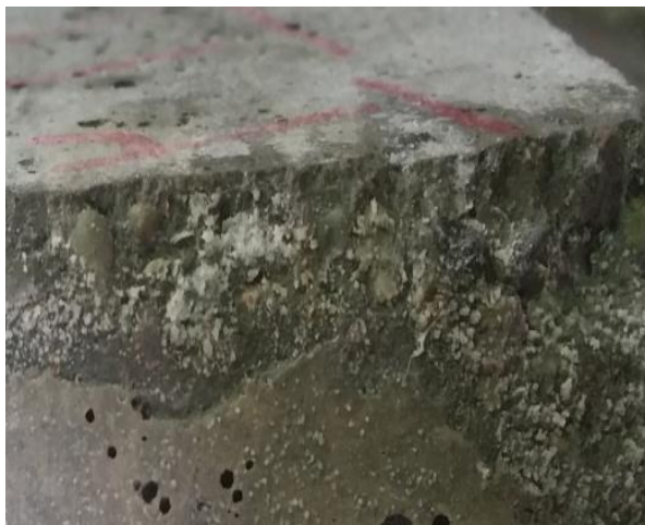
شکل ۶. تصاویری از تشکیل گچ و اترینگایت بر روی نمونه‌ها Fig. 6. Images of gypsum and ettringite formation on samples
