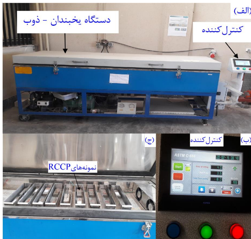
شکل ۷. الف) دستگاه F - T ، ب) صفحه نمایش دستگاه و ج) قرارگیری نمونه های RCCP در دستگاه
