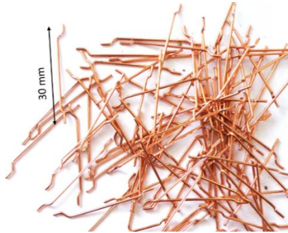
شکل ۱. الیاف فولادی دو سر قلاب دار [19] Fig. 1. Hooked steel fiber
