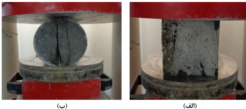
شکل ۲. الف) آزمایش فشاری، ب) آزمایش کششی غیرمستقیم [19] Fig. 2. The details of test setup (a) splitting tensile test; (b) compressive strength test
