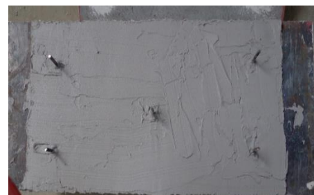
شکل ۱۳. کاشت مهارهای مکانیکی Fig. 13. Anchorage procedure
