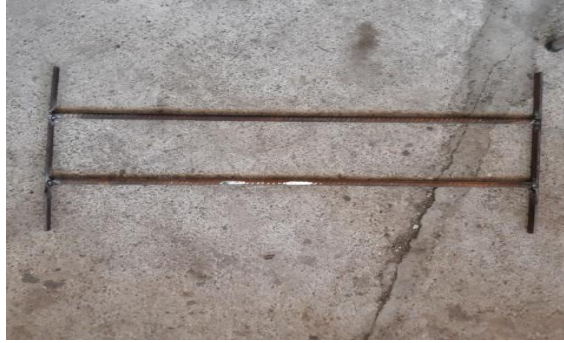
شکل ۴. مهار میلگردهای فولادی در ورق پیش ساخته Fig. 4. Anchoring of steel rebar's in HPFRCC laminate
