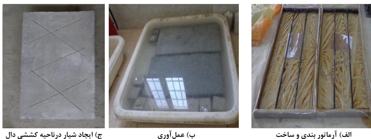
شکل ۳. نحوه ساخت ورق‌های پیش ساخته HPFRCC Fig. 3. The manufacturing process of laminates specimens a) laminate's rebar installation (b) laminate's wet curing (c) laminate's slotting
