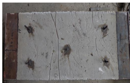
شکل ۱۳. کاشت مهارهای مکانیکی Fig. 13. Anchorage procedure
