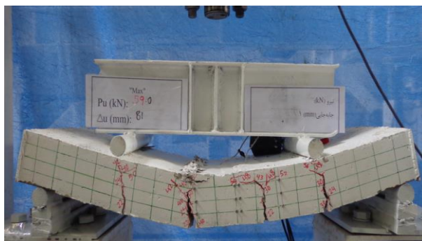
شکل ۲۳. الگوی شکست نمونه WS Fig. 23. The failure mode of the WS
