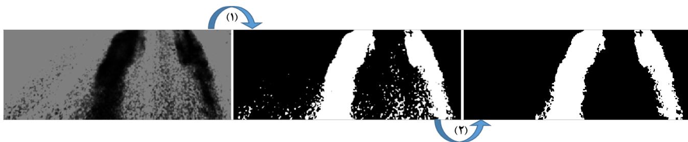
شکل ۱۳. فرآیند پس پردازش. ۱) آستانه گذاری سراسری، ۲) عملیات مورفولوژیک حذف اشیاء کوچک
